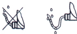
图4-7 防水接线示意图
